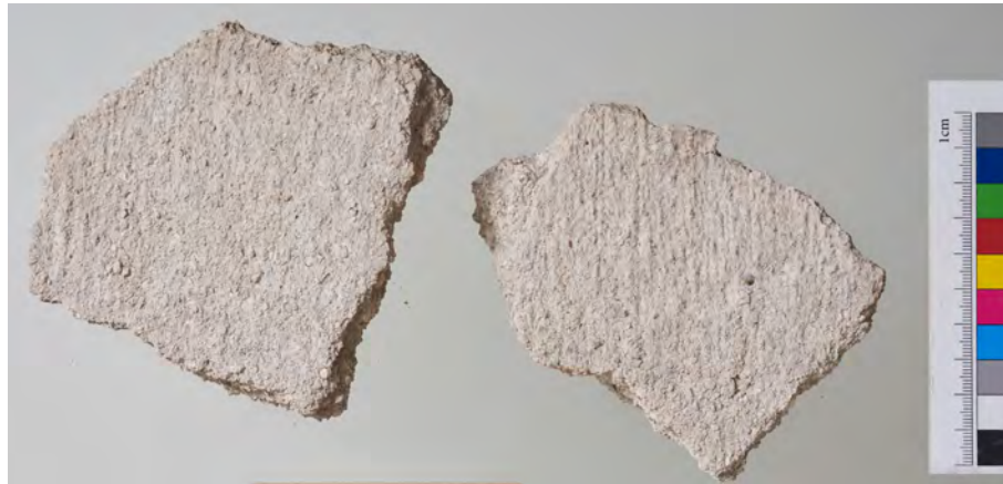
Abb. 29: Aussenwandverputz, geglättete Oberfläche; man beachte die starke Sandung der Mörtelmasse
