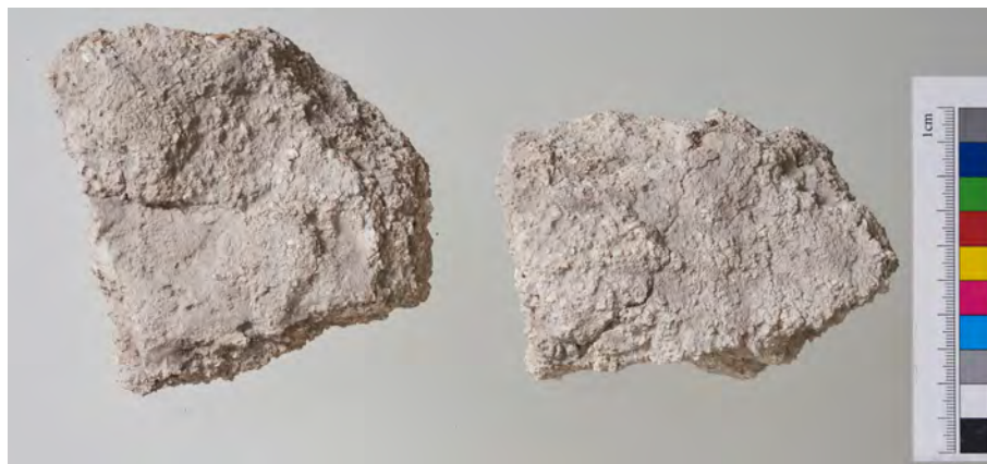
Abb. 29: Aussenwandverputz, geglättete Oberfläche; man beachte die starke Sandung der Mörtelmasse
