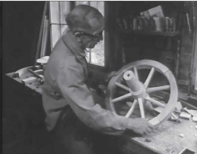
Abb. 6: Radmacher mit fast fertigem Rad (*Ein Rad entsteht*).
