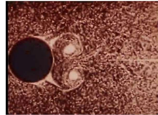
Abb. 3: Turbulente Strömung um eine Kugel. Links schematisch, rechts Originalaufnahme von LUDWIG PRANDTL (1875 – 1953) 4 .
