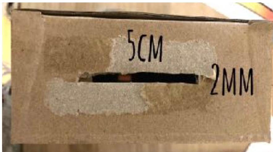
2. Auf der gegenüberliegenden Seite der Box schneide mit dem Cutter eine Ritze, so dass die CD in einem Winkel von etwa 30 Grad in die Box eingeführt werden kann. Lege den reflektierenden Teil der CD (Unterseite) in Richtung des Schlitzes.
