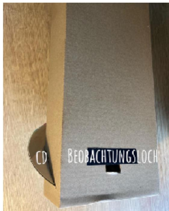
4. Benutze Isolierband, um die CD in der Ritze zu befestigen. Decke alle anderen Öffnungen, durch die das Licht eintritt, mit Isolierband ab, so dass nur das Beobachtungsloch und der Schlitz offen bleiben.
