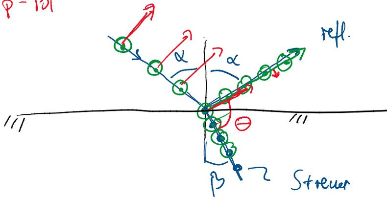
reflektierte Str.  $\perp$  gebrochener Strahl  $\theta = 90^\circ$
