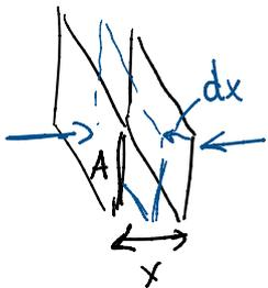
statischer Druck = potentielle Energiedichte an diesem Ort
