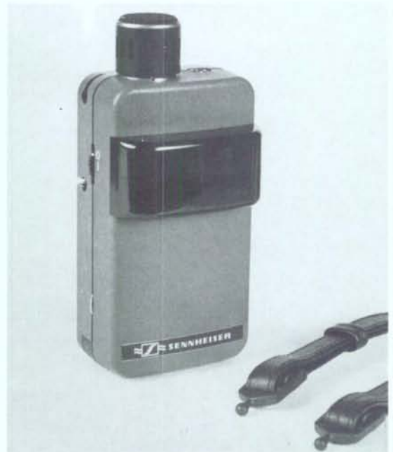
Abb. 6 Ansicht des Lehrersenders. Außer dem Elektret-Mikrofon ist eine Klinkerbuchse vorgesehen, um auch elektrische Signale beispielsweise von einem Tonbandgerät einspeisen zu können.
